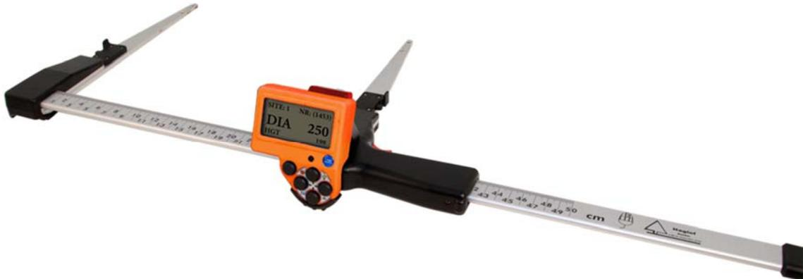
Le MDII est un instrument électronique moderne de mesure de diamètre. Il permet d'enregistrer, de stocker et de transférer les données de diamètre d'arbre, d'espèces (25) et de hauteur d'arbres vers des PC portables, des PC, des téléphones androïdes et des tablettes. La communication se fait sans câble via Bluetooth V2.0.
