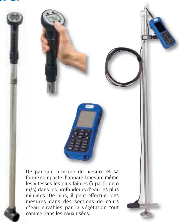
De par son principe de mesure et sa forme compacte, l'appareil mesure même les vitesses les plus faibles (à partir de 0 m/s) dans les profondeurs d'eau les plus minimes. De plus, il peut effectuer des mesures dans des sections de cours d'eau envahies par la végétation tout comme dans les eaux usées.
